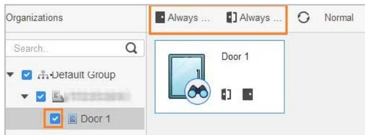
La puerta permanecerá abierta o cerrada todo el tiempo. Puedes hacer clic **Normal** para restaurar el control de acceso al estado normal, y luego la puerta se abrirá o cerrará según los métodos de verificación configurados.
